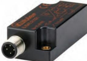
**Вимірюваний діапазон:**  $\pm 10^\circ$ ,  $\pm 45^\circ$ ,  $\pm 60^\circ$ . **Кількість осей:** 2. **Діапазон:**  $\leq 0.05^\circ$ ,  $\leq 0.1^\circ$ ,  $\leq 0.15^\circ$ . **Час реакції:** 0.1...0.5 с. **Тип виходу:** CANopen, аналоговий (4...20 mA, 0.1...4.9 V). **Напруга живлення:** 5 VDC, 10...30 VDC. **Особливості:** вібростійкість, захист від зміни полярності, коректирувка нуля  $\pm 5^\circ$ , швидкий монтаж та підключення.
