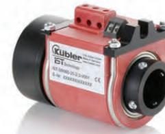
**Діаметр корпуса:** 60 или 85 мм. **Порожнистий вал:** 18...25 або 20...30 мм, 1". **Макс. швидкість:** 500 об./хв. **Силові кільця:** 240 VAC/DC, 16 A або 400 VAC/DC, 20 A. **Сигнальні кільця:** 48 VAC/DC, 2 A. **Кількість кілець:** 20. **Спеціальні версії:** пневматика, гіdraulіка. **Особливості:** просте підключення, вібростійкість, сигнали промислових мереж (Profibus, CANopen,...).
