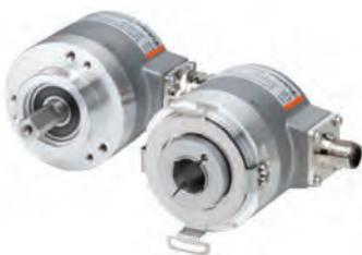
**Діаметр корпуса:** от 24 мм до 90 мм. **Діапазон:** ST 9...17 Bit, MT 29 Bit (17x12 Bit). **Напруга живлення:** 5...30 VDC. **Код:** Грей, бінарний. **Інтерфейс:** SSI, SSI+інкрементальний, SSI+Sin/Cos, BiSS, RS485, BiSS+інкрементальний, BiSS+Sin/Cos, Parallel, AWG-Pr., аналоговий (4...20mA, 0...10V), CANopen, Profibus, Profinet, ...
